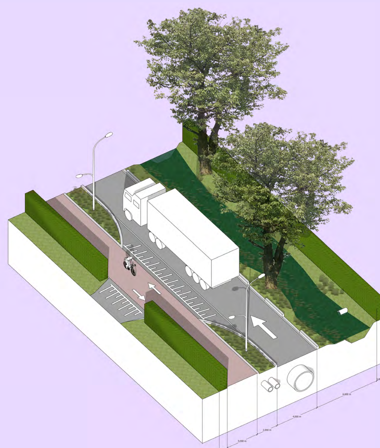
indicatief dwarsprofiel wegen in de bedrijvenzone
