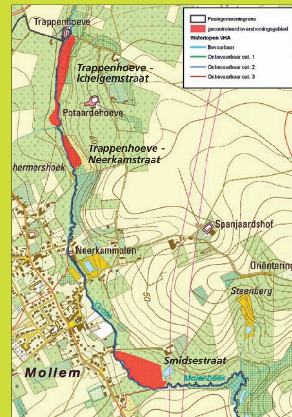
Gecontroleerde overstromingsgebieden Trappenhoeve - Smidsestraat
