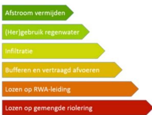
Figuur 28: Ladder van Lansink - toepassen van maatregelen inzake verwerking hemelwater. Bron: Leidraad ontwerpen van bronmaatregelen – Integraal waterbeleid
