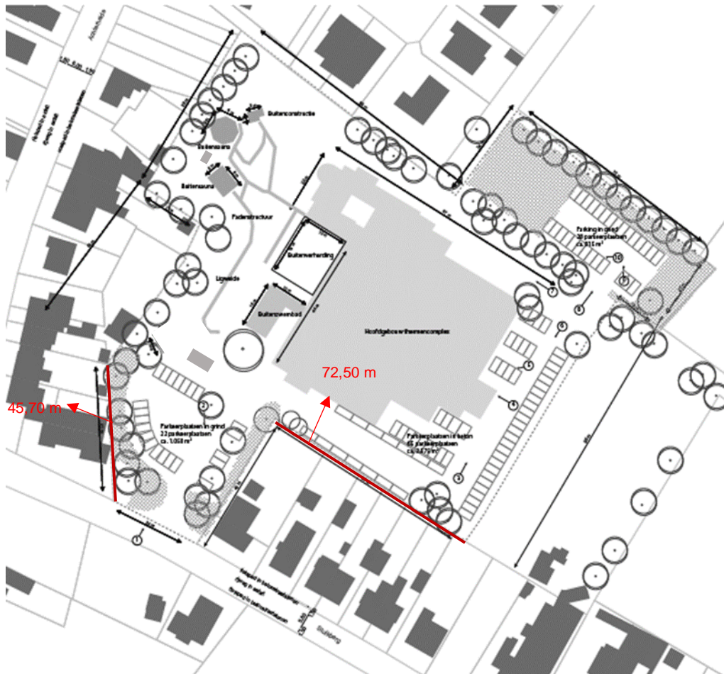
Figuur 23 Plaatsing geluidsschermen (in het rood aangeduid)
